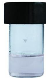
④ 擦净比色瓶外壁，将样品比色瓶放入比色瓶槽中锁定，静置1分钟（
